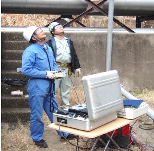
●地上での遠隔操作により測定
