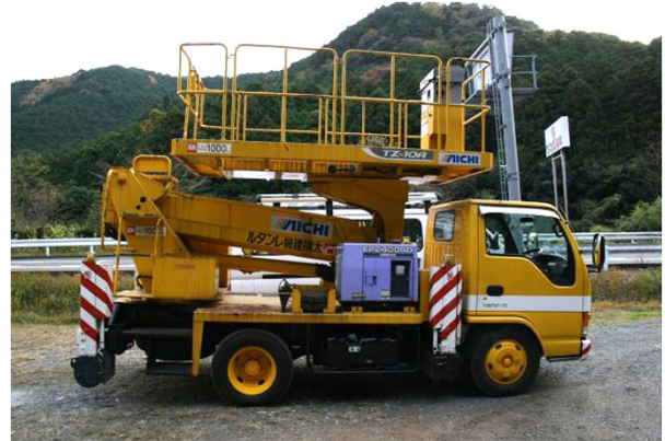
高所作業車【トンネル点検車】
